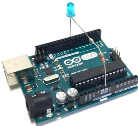
Abbildung 1: Arduino UNO mit LED samt Vorwiderstand
